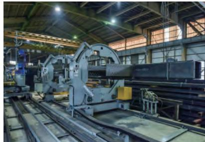
鉄骨柱大組立溶接口ボット(大)
