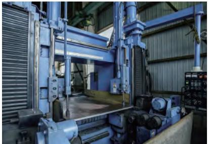
高精度高速開先加工機
